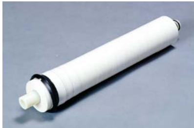
L'eau pénètre dans la cartouche et sous la pression d'alimentation, les molécules d'eau traversent la membrane, tandis que les autres molécules sont rejetées en permanence avec une partie de l'eau non filtrée.
