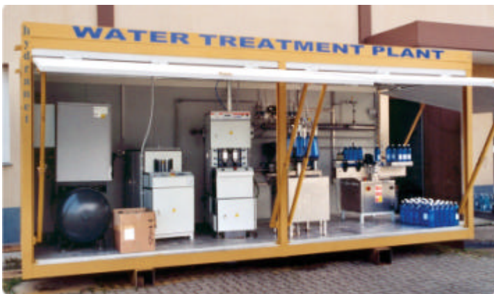
Mini usine transportable de potabilisation avec la mise en bouteille / Prefabriquée mobile drinking water treatment and bottling plant
